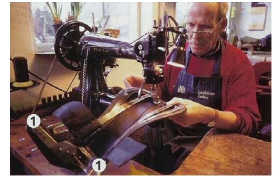
1. Således ser en stålfejersadelbom ud. Kopvidderne
